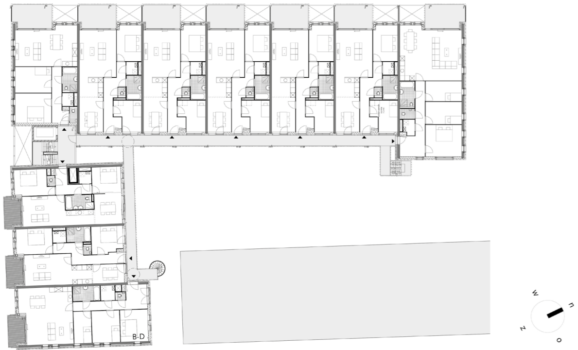
Plattegrond eerste verdieping. De woningen worden ontsloten door middel van een trap en lift. De trap ligt in het scharnierpunt van de twee gebouwdelen, de lift aan de hofzijde gelegen galerijen.
